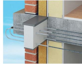
Rupteur thermique – structure béton
