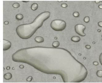
Enduits d'imperméabilisation perméables à la vapeur d'eau
